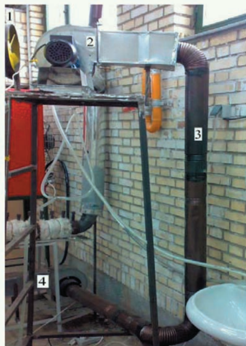
شکل ۴- مدار گازهای برگشتی ۱: فن خنک‌کننده، ۲: فن گازهای برگشتی، ۳: لوله گازهای برگشتی، ۴: فن هوا
