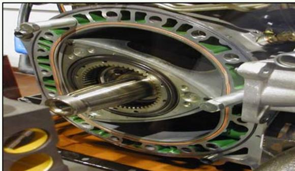
شکل ۱: روتور و استاتور
