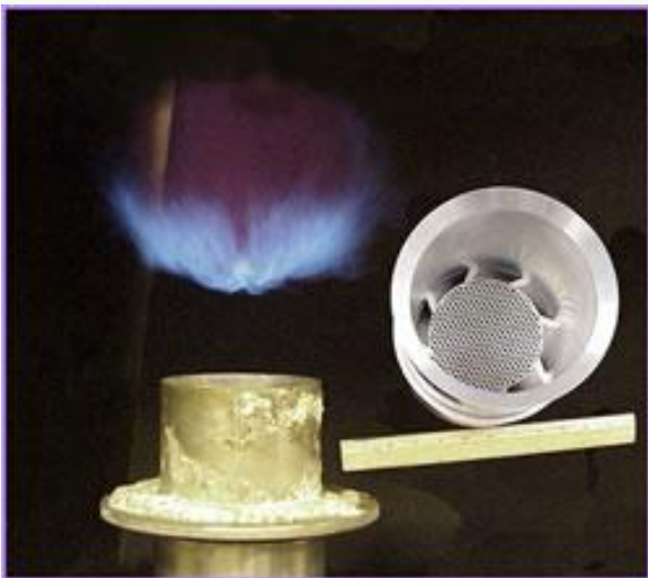
نمونه مشعل UCLSB طراحی شده برای دیگ های بخار، پریدگی شعله بهترین کارایی را برای لوله های دیگ بخار فراهم می کند.
