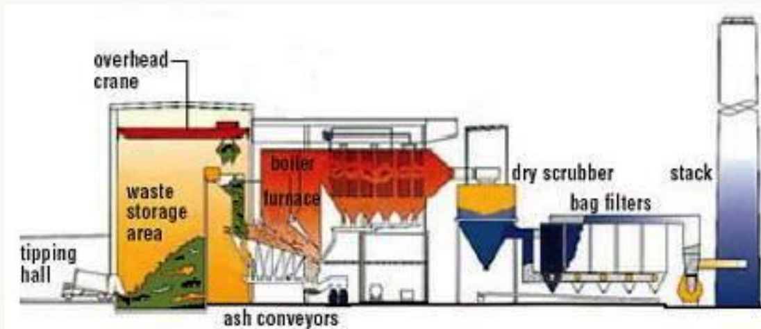
شکل ۳: زباله سوز کوره گردان به همراه سیستم کنترل آلودگی [۴]
