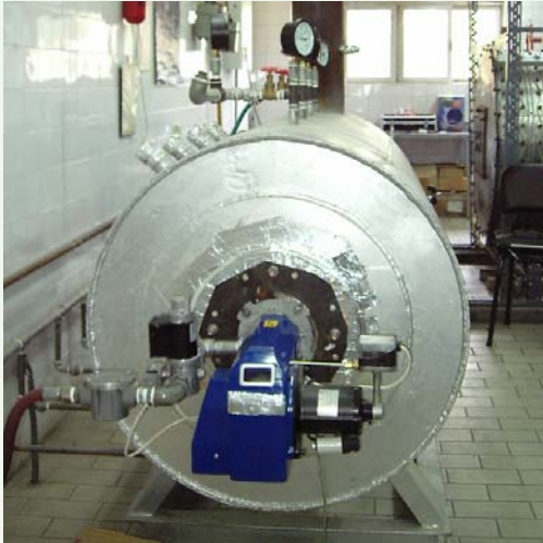
شکل (۱) - لوله آزمون شعله جهت آزمون استاندارد مشعل
