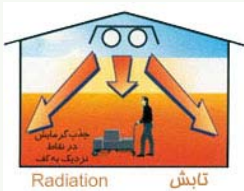
شکل ۱- نحوه انتقال حرارت در سیستم گرماتاب
