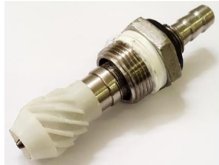
شکل ۴- چرخاننده‌ی جریان هوا و نازل سوخت بعد از مونتاژ
