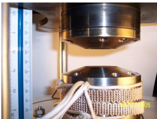
شکل ۱- نمایی از مشعل جریان متقابل پیش آمیخته
