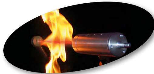
شکل ۱- شمایی کلی از یک لیزر عبوری از داخل شعله به منظور اندازه‌گیری غلظت گونه‌های میانی احتراق
