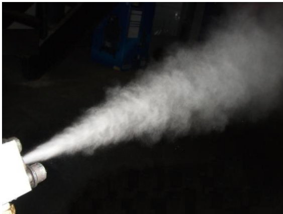
شکل ۵: پاشش آب بداخل منیفلد ورودی هوا.
