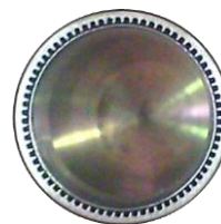
شکل ۴. هندسه انژکتور سوخت مشعل SGTMC
