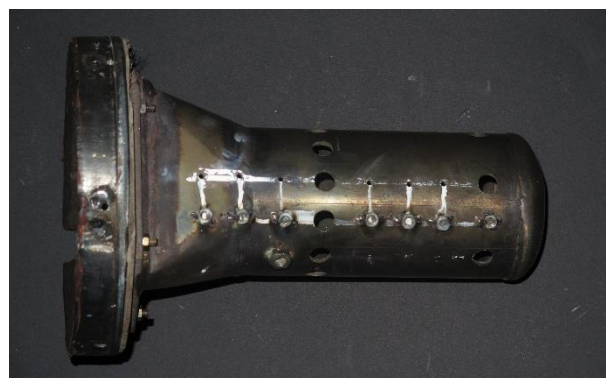
شکل ۲. نمای کلی محفظه احتراق لوله‌ای مورد استفاده
