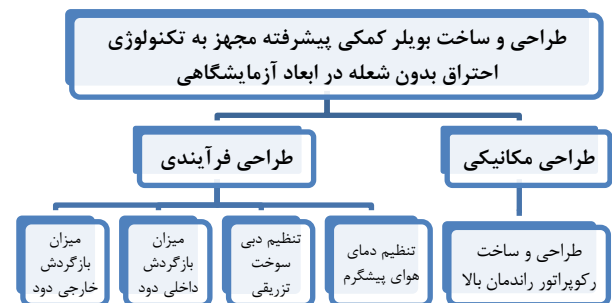
شکل (۱۶) مراحل اصلی پیاده‌سازی رژیم احتراق بدون شعله در بویلر آزمایشگاهی موجود
