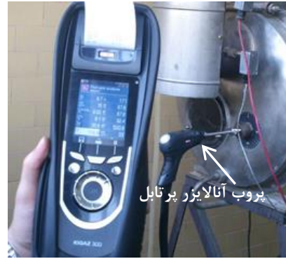
شکل (۱۵) اندازه‌گیری ترکیب درصد محصولات احتراق
