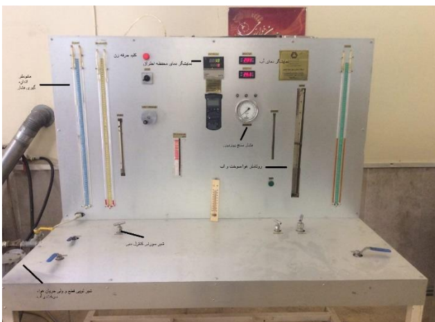
شکل ۳- میز آزمایش مشعل متخلخل - چرخشی
