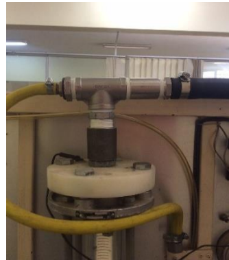
شکل ۴- اجکتور گازی در محل اختلاط سوخت و هوا
