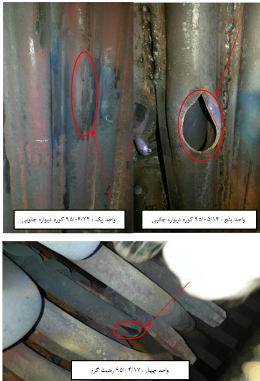
شکل شماره ۱۰: نمایش لوله های دچار عیب بیش گرمایش بلند مدت شده.
