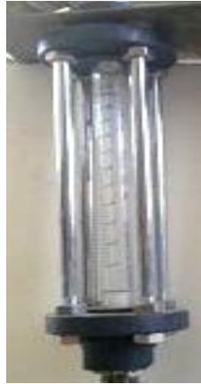
شکل (۳): روتامتر به کار رفته برای اندازه‌گیری دبی گاز
