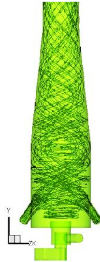
شکل ۱۱- ورودی گاز پسماند، دایروی، ۴۵ درجه بسمت بالا و مماس بر دیواره کوره.
