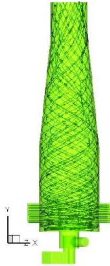
شکل ۶- ورودی گاز پسماند، مستطیلی شکل، مستقیم و مماس بر دیواره کوره.
