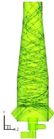
شکل ۹- ورودی گاز پسماند، مربعی شکل، ۴۵ درجه بسمت بالا و شکل ۱۰- ورودی گاز پسماند، مستطیلی شکل، ۴۵ درجه بسمت بالا و مماس بر دیواره کوره.
