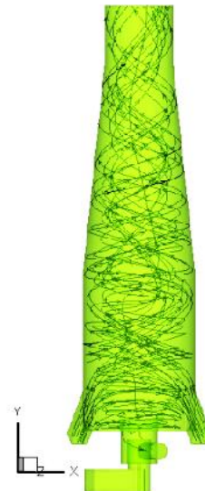
شکل ۹- ورودی گاز پسماند، مربعی شکل، ۴۵ درجه بسمت بالا و شکل ۱۰- ورودی گاز پسماند، مستطیلی شکل، ۴۵ درجه بسمت بالا و مماس بر دیواره کوره.
