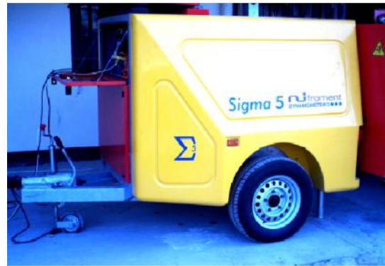
شکل ۲- دینامومتر مدل 5 ساخت شرکت NJ-FROMENT
