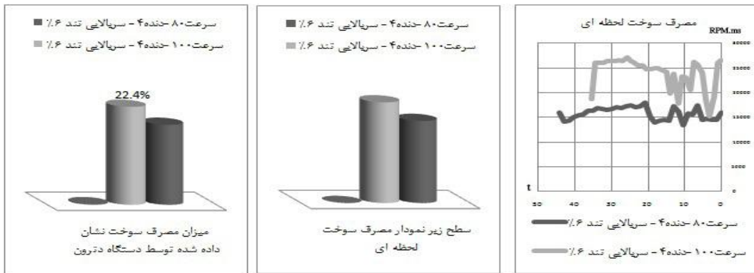
شکل ۸- تاثیر سرعت خودرو بر مصرف سوخت در مسیر با سربالایی ۶٪ در دنده ۴ و سرعت های ۸۰ و ۱۰۰ کیلومتر بر ساعت
