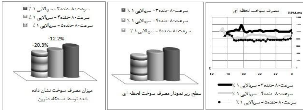
شکل ۲- تاثیر انتخاب دنده‌های مختلف بر روی مصرف سوخت در یک مسیر با شیب ملایم ۱٪ با سرعت ۸۰ کیلومتر بر ساعت
