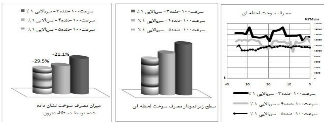
شکل ۳- تاثیر انتخاب دنده‌های مختلف بر روی مصرف سوخت در یک مسیر با شیب ملایم ۱٪ با سرعت ۱۰۰ کیلومتر بر ساعت
