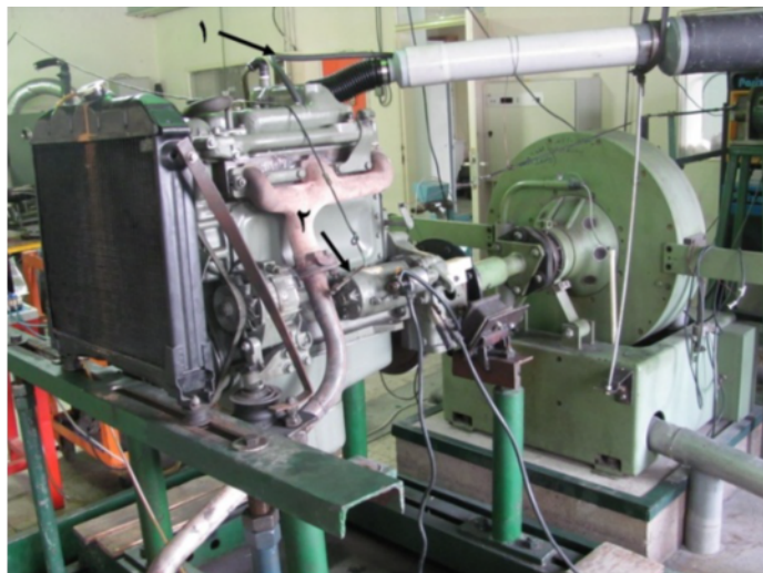
شکل ۱- بستر آزمون موتور مجهز به دینامومتر، (۱) سیم انتقال سیگنال فشار درون سیلندر، (۲) ترموکوپل
