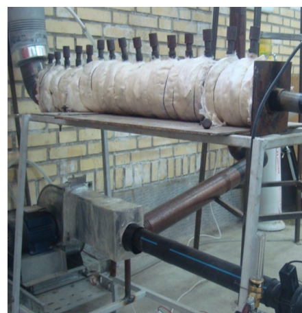
شکل ۱- قسمت آزمایش. ۱، پروپان؛ ۲، روماتر؛ ۳، چرخنده؛ ۴، کوره؛ ۵، ترموکوپل؛ ۶، آنالیزور گاز؛ ۷، میله اندازه گیری؛ ۸، فن هوا، ۹، فلومتر
