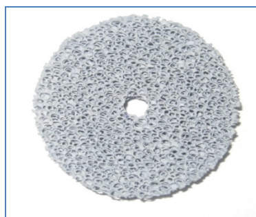
شکل ۲. محیط متخلخل سوراخ شده از جنس سرامیک SiC
