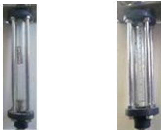
شکل ۴- تصویر روتامترهای اندازه‌گیر دبی گاز و هوا
