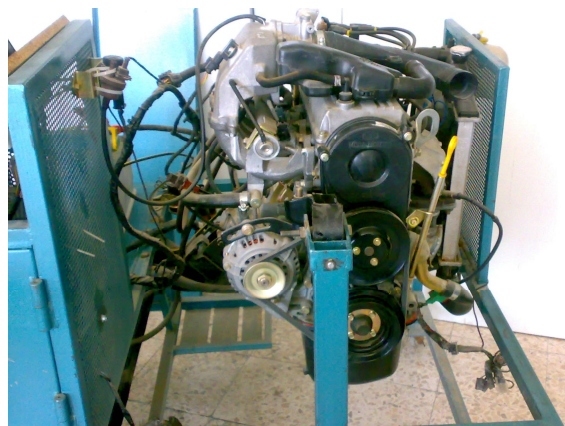
شکل 1- موتور احتراق داخلی چهار زمانه مستقر در محیط آزمایشگاه
