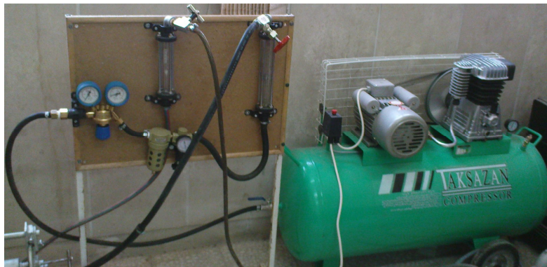
شکل ۳- نحوه اتصال فیلتر هوا و روتامترها
