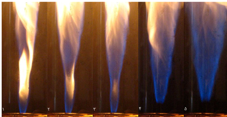
شکل ۷- تغییرات شکل شعله گاز طبیعی با افزایش سرعت سوخت و عدد چرخش ۰/۸ و سرعت هوا ۰/۶۴ متر بر ثانیه
