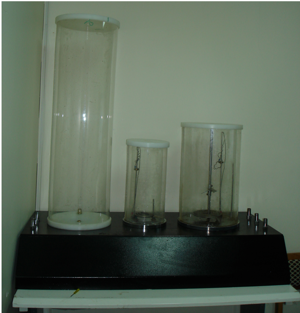
شکل ۴- دستگاه تمام اتوماتیک جدید برای تولید سوخت بیودیزل از روغن پسماند
