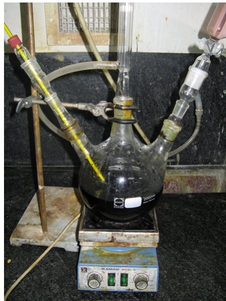
شکل ۷- شمای تجهیزات مورد نیاز جهت سنتز آزمایشگاهی ۲-(۴و۲-دی نیترو فنوکسی) اتانول
