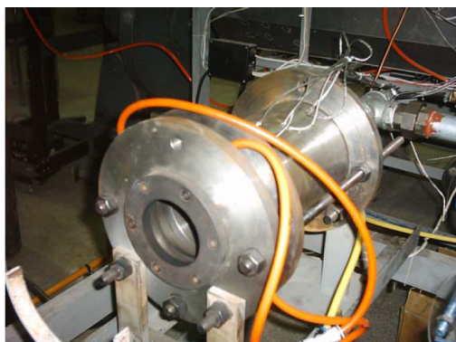
شکل (۴) - موتور گردابه‌ای ساخته شده در قطب علمی تبدیل انرژی دانشگاه صنعتی شریف
