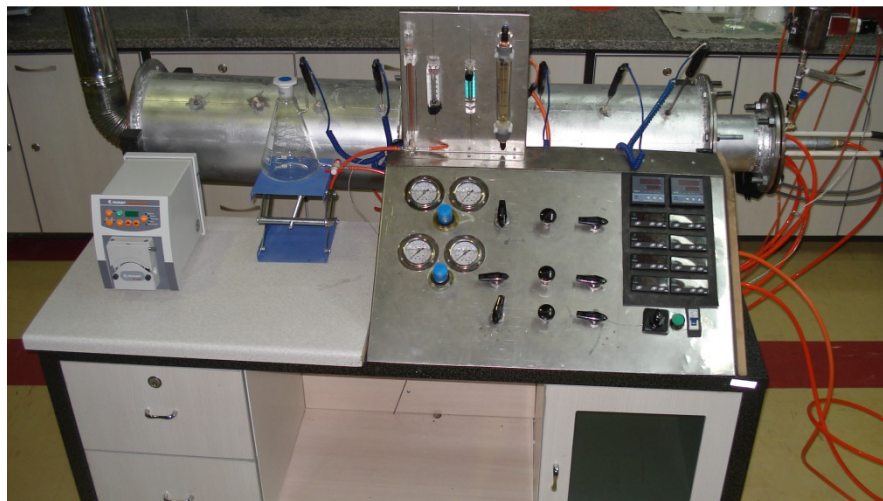
شکل ۲. پایلوت ساخته شده به منظور بررسی عملکرد مشعل‌ها و کوره‌ها
