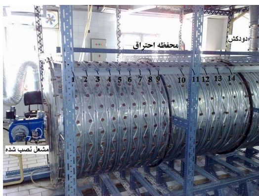
شکل ۱- کوره و مشعل نصب شده روی آن
