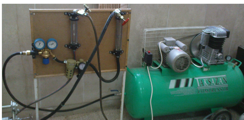
شکل ۲- نحوه اتصال فیلتر هوا و روتامترها به کمپرسور
