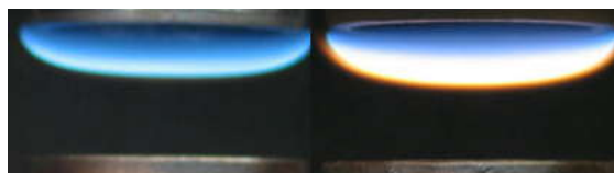
شکل 2- مقایسه بین شعله پروپان (سمت چپ) و گاز شهری (سمت راست). مقدار strain rate برابر 20 \text{ s}^{-1} ، سوخت شامل 30 درصد پروپان (گاز شهری)، V_F=1
