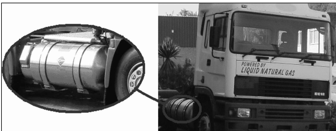
شکل 7- نمونه‌ای از مخازن  $\text{LNG}$  جی در یک خودروی سنگین.
