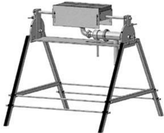
شکل 5- دو نمای کلی از مجموعه مشعل ساخته شده
