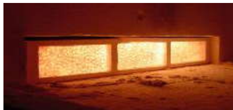
شکل 3- نمونه ای از مشعل متخلخل تابشی تخت
