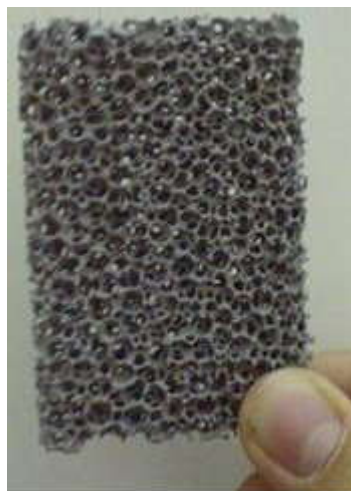
شکل 6- نمونه ای از سرامیک فومی استفاده شده از جنس SiC
