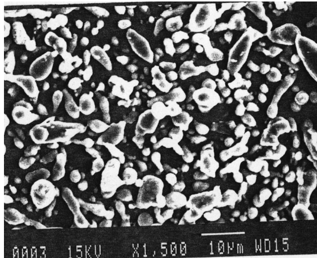
شکل 2. تصویر ذرات آلومینیم 5/4 میکرون
