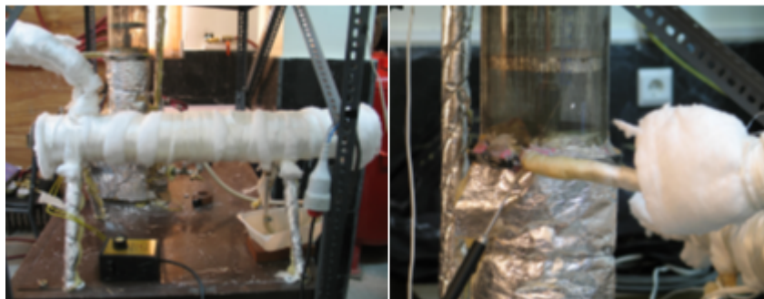
شکل ۳- هیتر الکتریکی و نحوه اتصال آن به سیستم
