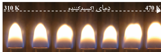
شکل ۵- تغییر شکل شعله نفوذی گاز طبیعی واکسیدکننده (80% Air+20% O 2 ) در شرایط (Q oxidizer = 36 l/min و Q f = 65ml/min)
