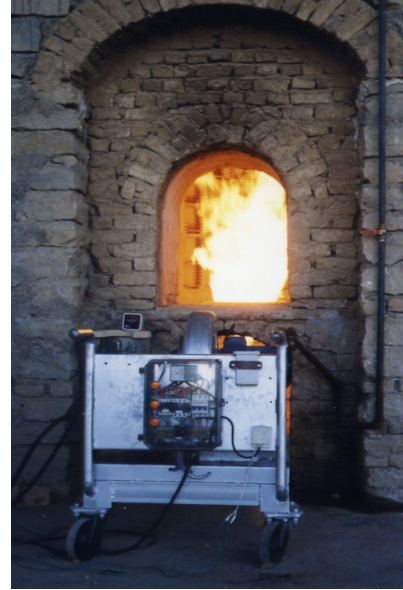
شکل ۷- مشعل اتوماتیک ساخته شده در حال آزمایش
