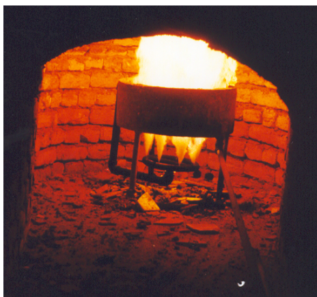
شکل ۲- مشعل فعلی کوره‌های پخت سرامیک و کاشی
