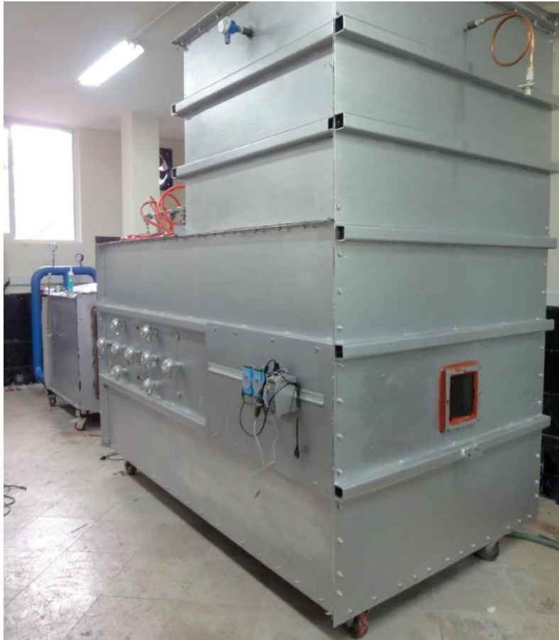
شکل ۱- نمای کلی کوره ی اصلی و کوره ی پیش گرم
