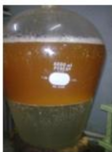
مخلوط بیودیزل و آب ← جداسازی آب و بیودیزل ← بیودیزل خالص
