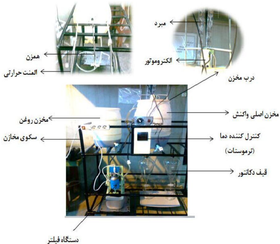
شکل ۳- تجهیزات تولید بیودیزل
