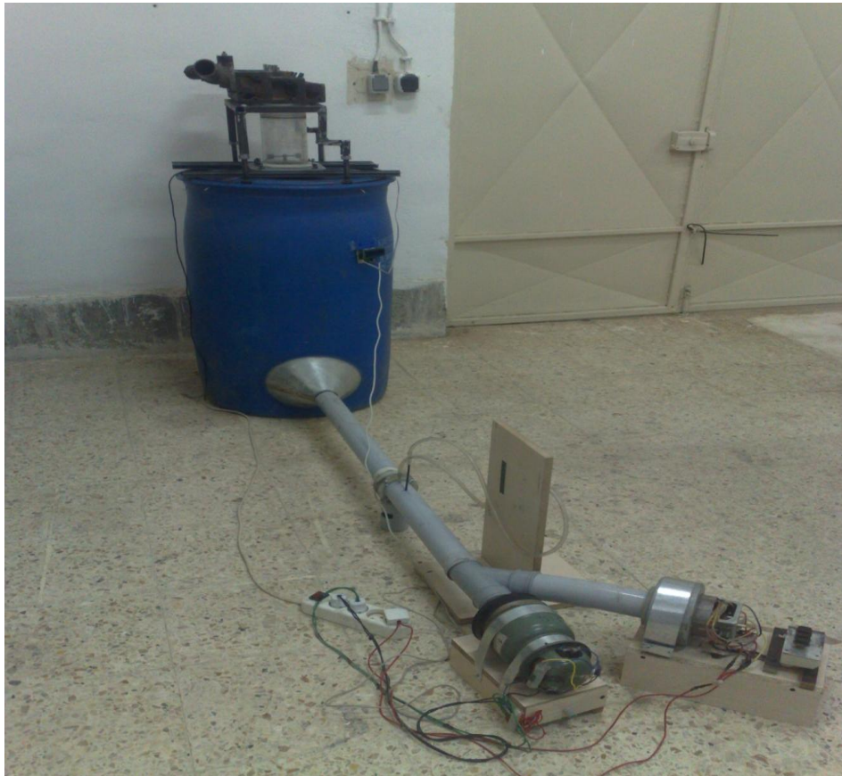
شکل (1) دستگاه چرخش سنج ساخته شده در این تحقیق [7].
