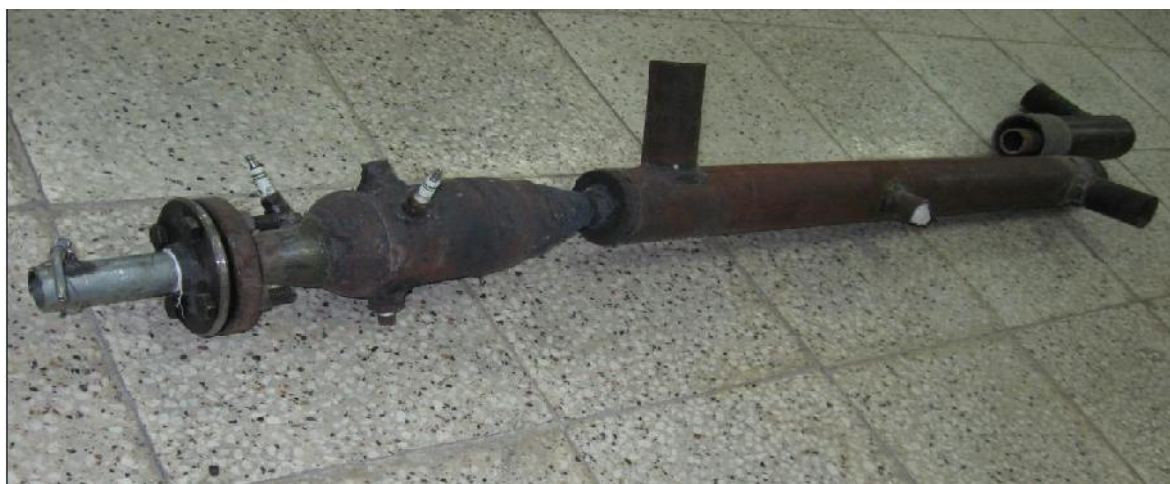
شکل ۱ - محفظه احتراق ضربانی هلمهولتز با شیر ایرودینامیکی مورد استفاده در آزمایشات
