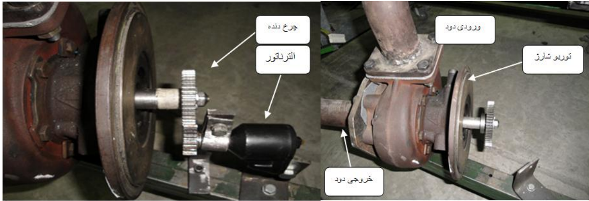
شکل ۱- نحوه نصب و موقعیت قرارگیری توربوشارژر
