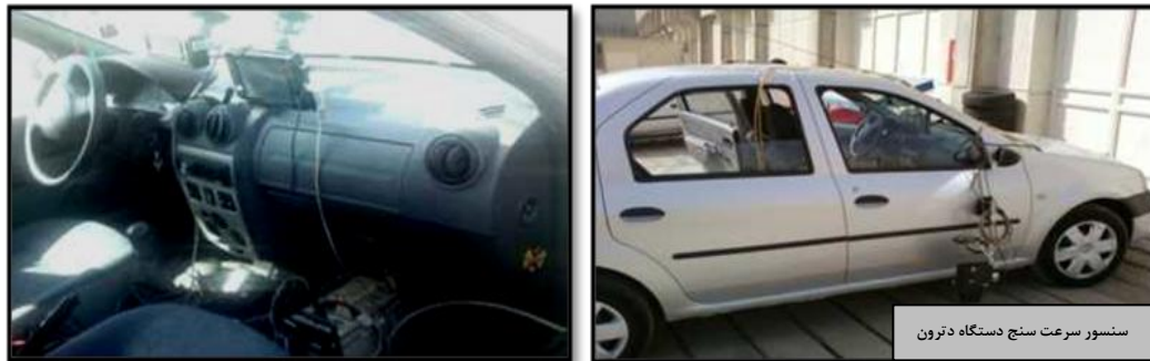
شکل ۱- خودرو مجهز شده به دستگاه های اندازه گیری
