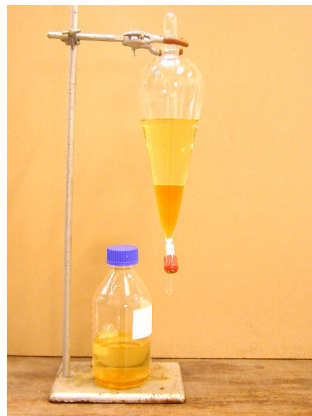
شکل ۲- جداسدن فاز استری (بیودیزل) از فاز محتوی گلیسرین، فاز استری به دلیل دانسیته کمتر بالا قرار می گیرد.
